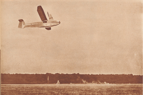
Für 304 von welthistorische Bedeutung. Die erste Aufnahme vom Menschenflug am eigenen Kraft. Zahn Meter über der Erde. Flieg: Dinnbühl mit etwa 10 Meter Sekundengeschwindigkeit dahin. Der Propeller machte 350 Umdrehungen in der Minute.
