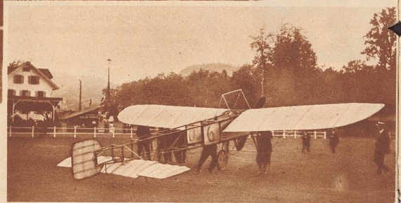
Unten: Der Blériot-Eindecker «Kanaltype» mit einem 25 PS Anzani-Motor des französischen Piloten Kuhlring. Es ist der Flugzeugtyp, mit dem Blériot am 25. Juli 1909 als erster den Aermelkanal überflog und mit dem nachher der Schweizer Flieger Bider die ersten großen Flüge in seiner glänzenden Karriere absolvierte.
