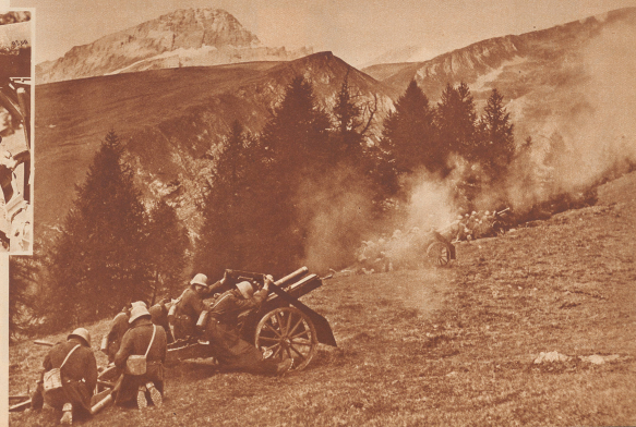
Der Raboter am Auslastungsrennen. Seine Arbeit erfordert große Geschwindigkeit und Zuverlässigkeit. Die Schützen der Gebirgsartillerie erfolgt im wesentlichen auf indirektem Wege. Das Auslastungsrennen ermöglicht es, auf dem Wege über ein beliebiges Höhenmaß das Geschützrohr auf ein unüberschaubares Ziel zu richten.
