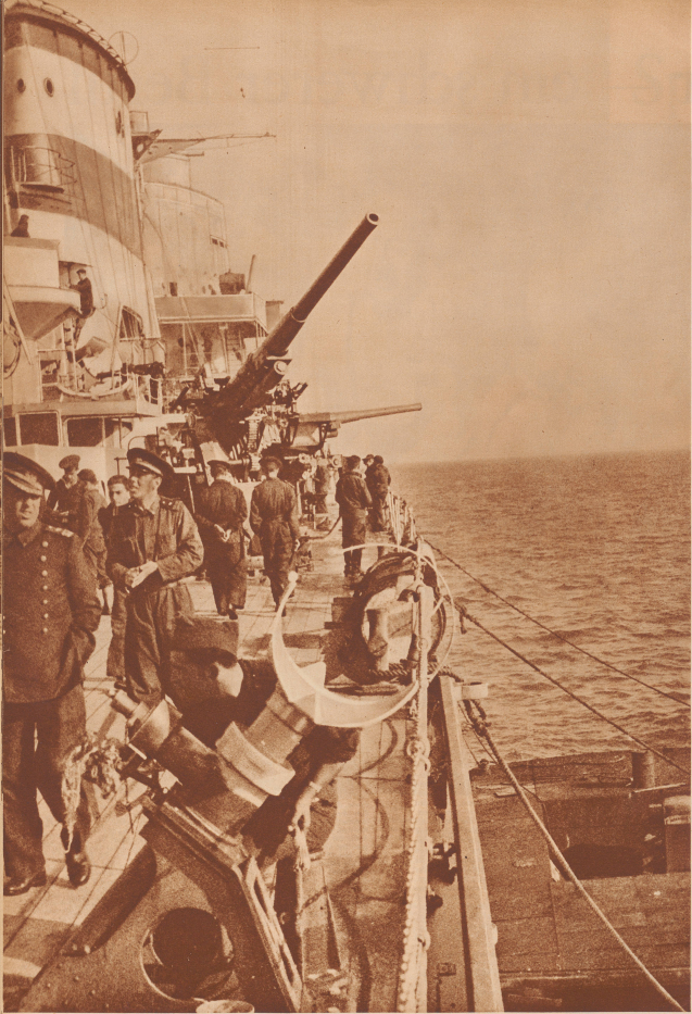
Kein Feind im Sicht. Blick auf den Deck des Kreuzers «Canarias» zur Zeit einer Ausrüstungsarbeiten. «Canarias» und «Balears» gelten als «Flotte de l'Espagne» der spanischen Flotte. Sie wurden in den Jahren 1930/31 erbaut, sind ausgestattet mit je 8 Geschützen von 30,5 cm Kaliber, 8 Geschützen mit 12 cm Kaliber, 8 modernen Flugabwehrkanonen und 12 Torpedorohren von 53,3 cm Durchmesser. Außerdem befinden sich auf jedem der beiden Kreuzer 2 See-Flugzeuge. Die beiden Schiffe verdrängen 11 000 Tonnen, die Fahrgeschwindigkeit beträgt 35 Knoten.
