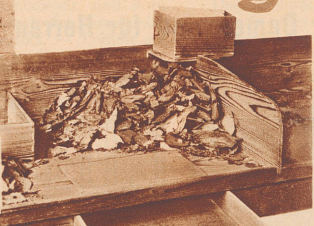
Der Tabak wie er den Ballen entnommen wird, ist zwar am Ursprungsort schon flüchtig gereinigt, enthält aber noch Sand und Staub. Er wird zuerst in einem Raum mit Klima-Anlage gelagert, damit die trockenen Blätter hinreichend Feuchtigkeit aufnehmen.
