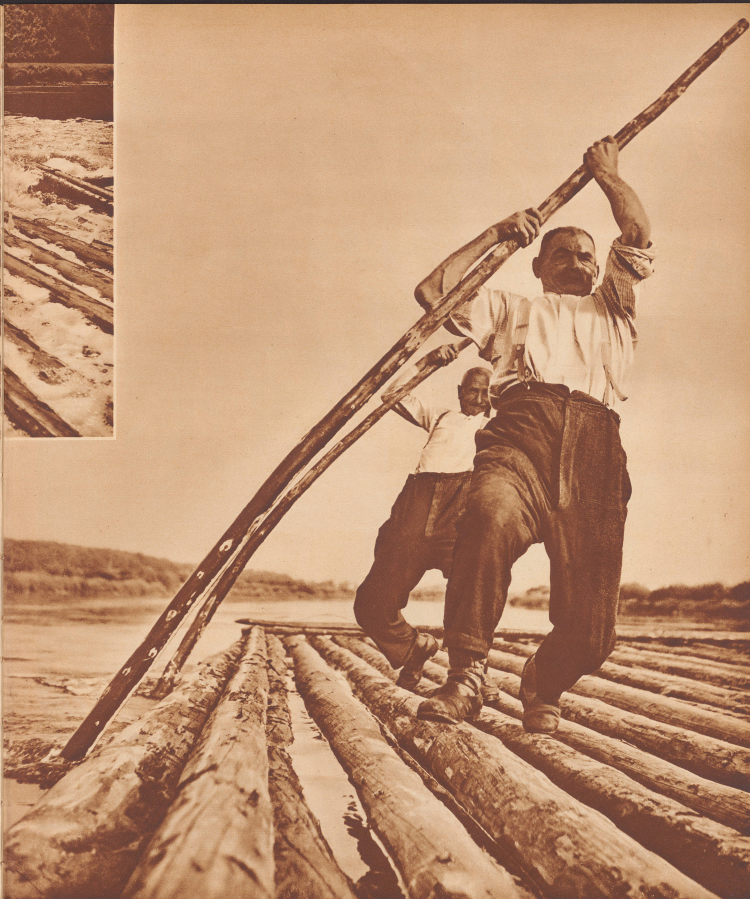
Im Tempo von 10 bis 40 Stundenkilometer schwimmen das Floß den Main hinunter. Mit ihren 6 Meter langen Flößestangen, Stangen genannt, haben zwei Leute das Floß beständig in der Schweimgewandlung. Einmalen über die Ufer zu vermeiden und setzen das Floß elegant um die Mauwöhlungen und zwischen den Brückenjochen hindurch. Diese Arbeit, die beträchtlichen Muskelaufwand und große körperliche Gedächlichkeit erfordert, nennt man i. Söcken. Des attitudes particulières. Entre Schwinzer et Ochsenbar, le floue coule à une vitesse de 30 à 40 kilomètres-heure. Menés de gaffes de 6 mètres, le compagnon et ses aides dirigent le radeau et le maintiennent dans le courant. Cet exercice exige autant d'adresse que de force.
