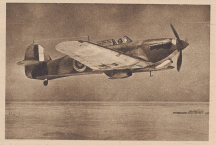
Eine englische Hurricane-Jagdmaschine auf Patrolleinsatz über dem Sandmeer der Libyschen Wüste. Gegen das Eindringen von Sand und Staub sind diese Apparate mit einer besonders guten Verkleidung versehen.
