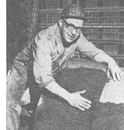
vor dem Aufsetzen des Formkastens: Giesser Josef Siger klopft den Modellhand an das Modell eines Dieselmotorkolbens.
