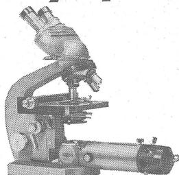
**Olympus -MIKROSKOP, Mod. EC-BI** binokular mit koaxial verstellbarem Kreuztisch CS, Binokulartubus 1:1, Kondensator N. A. 1.25 auf Zahntrieb, 4 Objektiven, Achromaten 4x, 10x, 40x und 100x (Oelimmersion), Okularpaar Weitwinkel WF 10x, (Grossfeld), mit Plastik-Haube, Holzschrank, Augenmuscheln und **Hochleistungs-Niedervolt-Lampe 6V/30W**, inklusive 3 Birnen, Filter, 1 Flacon Oelimmersion und stufenlos regulierbarem Transformator 220V.
